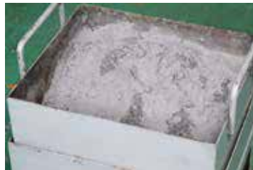
加工機：無心磨床 材質：鋁
