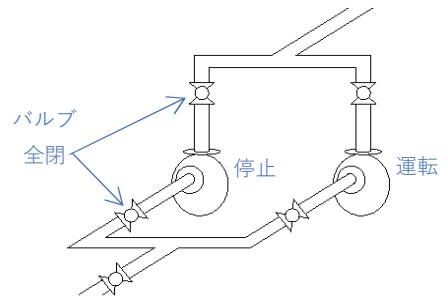
(10) ポンプ停止中、移送液が凝固する恐れがある場合は、ポンプ内部に通水（フラッシング）をしてポンプ内部に凝固しないように注意してください。ポンプにフラッシングや呼水吸水装置を設置する場合は、急激な圧力上昇がないように十分に注意して、最大0.3MPa以下にしてください。 **重要**
