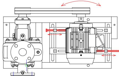
③ 電動機の位置が決まったら、電動機の取付ボルトを確実に締めてください。
